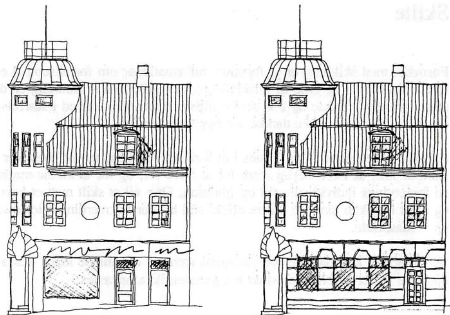
Eksempel på facaderenovering, før og efter.
