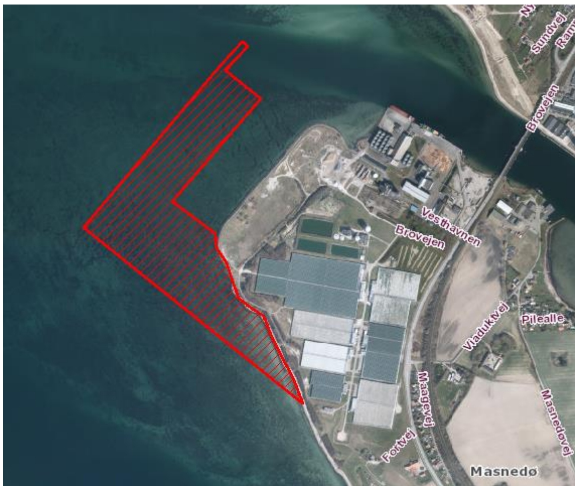
Plan for udvidelsen af Vordingborg Havn. Det rødskraverede areal er havneudvidelsens etape 4 og 5, der i denne baggrundsrapport beskrives som et nyttiggørelsesprojekt for overskudsjord.
