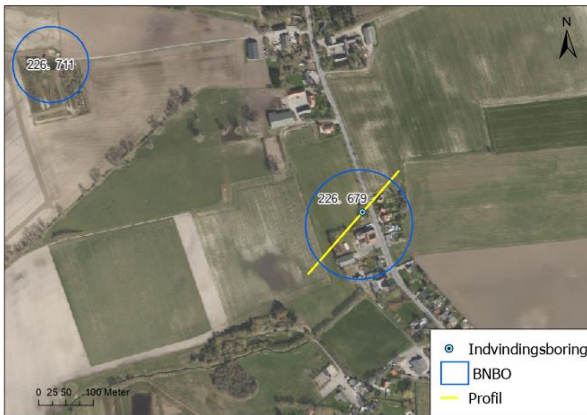
Figur 4.1 Luftfoto over BNBO til Allerslev-Ammendrup Vandværk. Den gule linje viser forløb af profilsnit vist på Figur 4.6.
