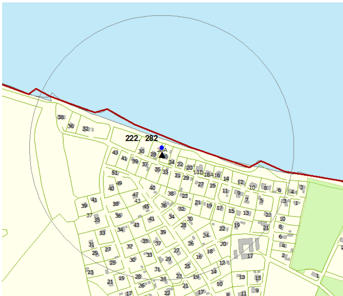
Fig. 2 Kohaven Roneklint vandværk ▲ og aktive bornings placering ●, samt 300 meters beskyttelseszoner omkring boringer.
